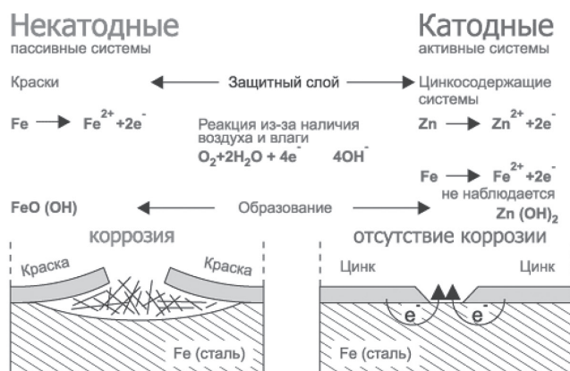
Рис. 1. Влияние холодного цинкования на процесс коррозии металла
