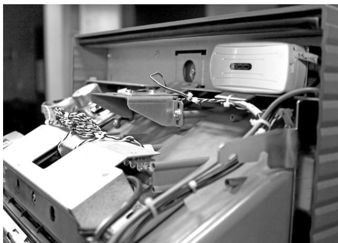
Рис. 3. Совмещенный извещатель «Шорох-3»
