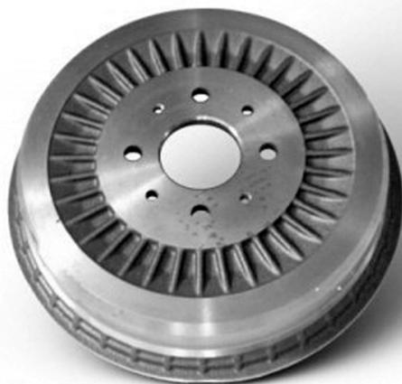
**Рис. 6. Тормозной барабан с ребрами отвода тепла**
