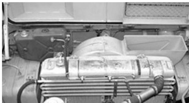
**Рис. 5. Размещение паровоздушного клапана в расширительном бачке**
