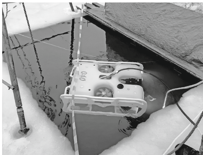
Рис. 3. Погружение ТНПА «Марлин-350» в рамках эксперимента
