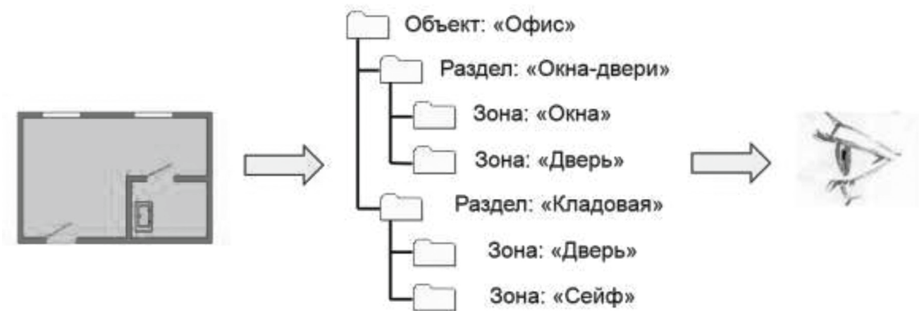
Рис. 5. Пример структуры охраняемого объекта в «компьютерном» виде
