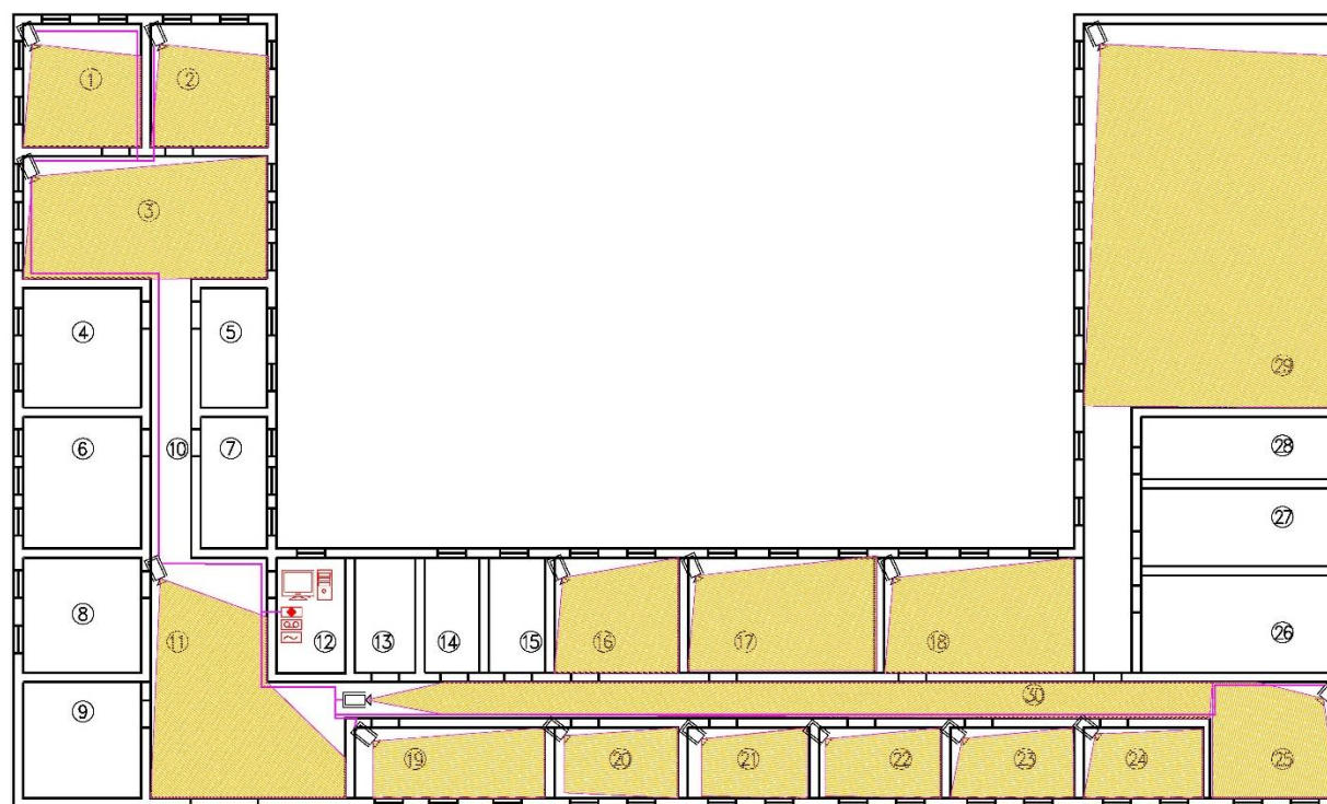
План расположения видеокамер СОТ в помещении
