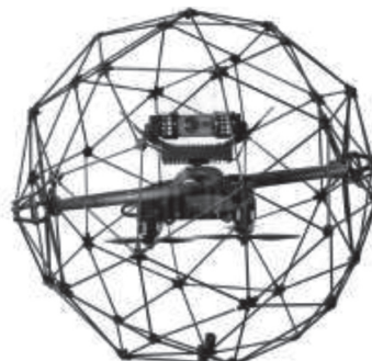
Рис. 3. БВС мультироторного типа (квадрокоптер), помещенный в сплошной защитный кожух [3]
