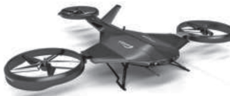
Рис. 2. БВС гибридного БВС (конвертоплан) с системой защиты винтов [2]
