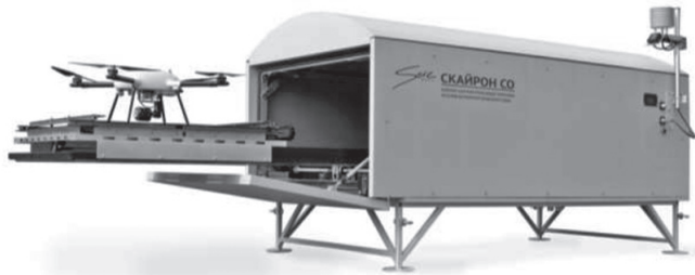
Рис. 3. Вылет БВС «Скайрон ПС» из стартового контейнера
