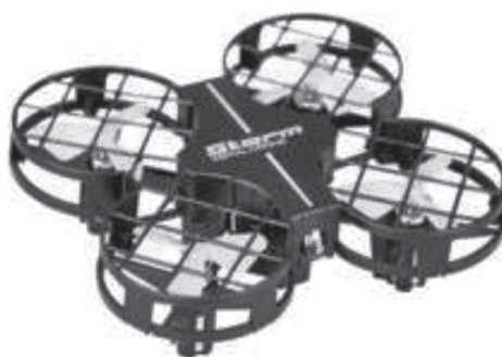
Рис. 1. БВС мультироторного типа (квадрокоптер) с системой защиты винтов [1]
