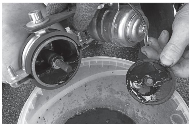
Рис. 6. Вид фильтра-сепаратора и частиц загрязнений
