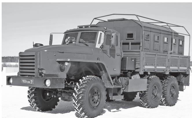
**Рис. 8. Автобус специальный бронированный «Федерал-42591» на базе Урал-4320**
