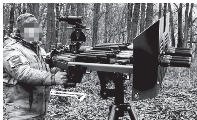
Рис. 13. Установки для поражения БВС (слева – ПКТ, справа – АК-74)
