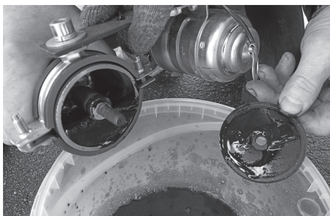
Рис. 6. Вид фильтра-сепаратора и частиц загрязнений
