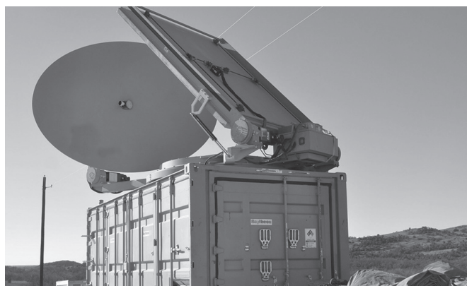
Рис. 12. СВЧ-установки для поражения БВС: Китай (слева), США (справа)
