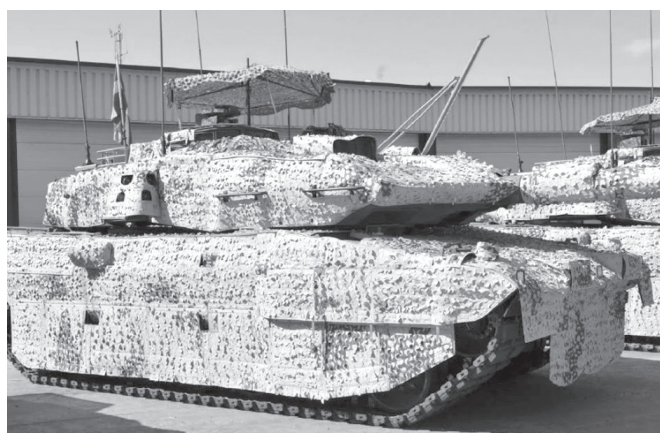
Рис. 8. Танк «Леопард-2 A7V» с покрытием Barracuda MCS
