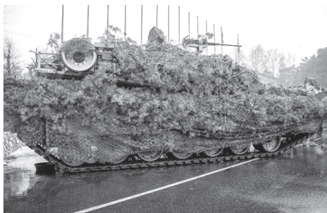
Рис. 6. Вариант маскировки танка «Абрамс» под фон местности с применением маскировочного покрытия
