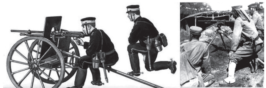
Японские пулеметчики у раннего пулемета «Гочкис» на артиллерийском лафете (слева) и у пулемета «Гочкис» (на треноге) (справа)
