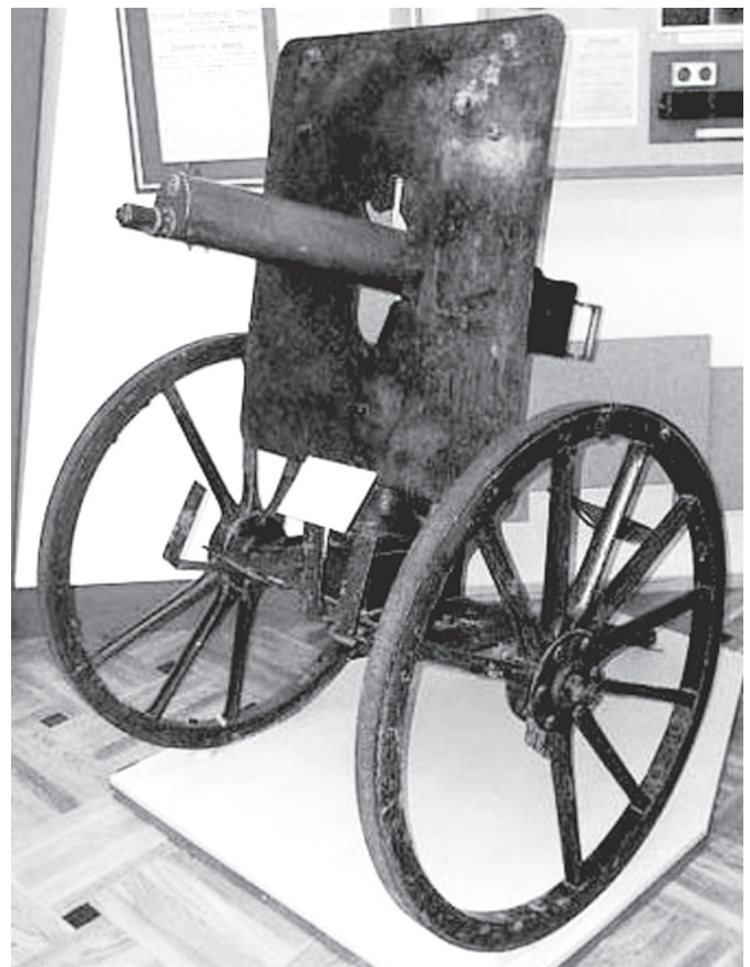
Рис. 8. Пулемет Максима с броневым щитом, установленный на артиллерийском лафете
