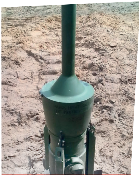
Редкий и опасный трофей – немецкая противотанковая мина PARM. Может поражать технику в борт на расстоянии от 5 до 100 метров. Оснащена батареей, обеспечивающей нахождение в боевом положении до 40 суток.
