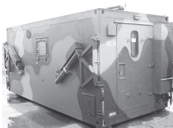
Рис. 2. Мобильный пункт хлебопечения МПХ-2 М
