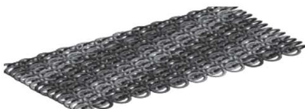
Рис. 1. Структура бронеполотна с нерегулярными поверхностью и объемом
